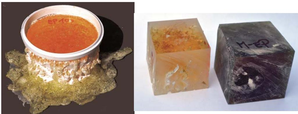
Abb. 42: Schmelzen des Aufnahmegefäßes durch hohe Reaktionstemperaturen eines Harzes. Zwei reine Harz-Würfel (oben). Quarzsand-Harzwürfel (unten).
