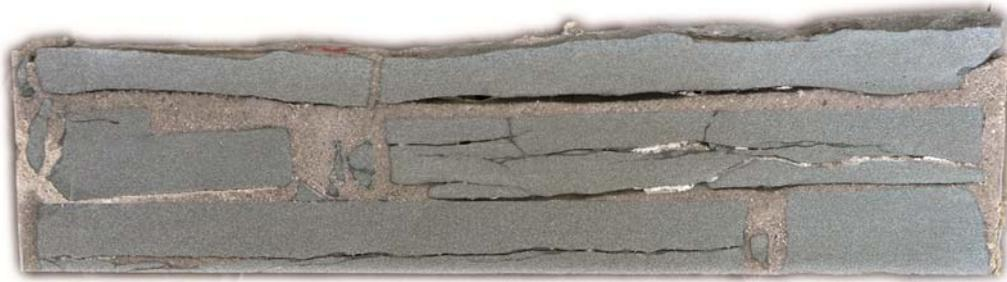
Abb. 41: Querschnitt eines mit Reaktionsharz verfüllten "Chaoskörpers": das Harz hat die Quarzkörner zum Teil weggeschoben, die glasig verfüllten Bereiche erscheinen schwarz.
