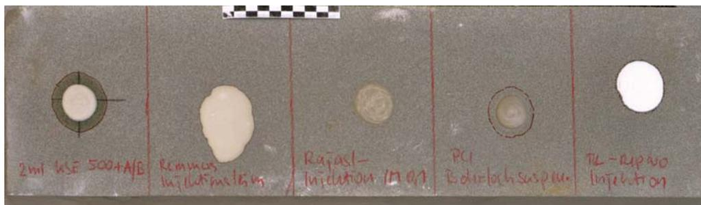
Abb. 43: Ausbreiten von jeweils 2 ml Injektionsmaterial auf Sandstein.
