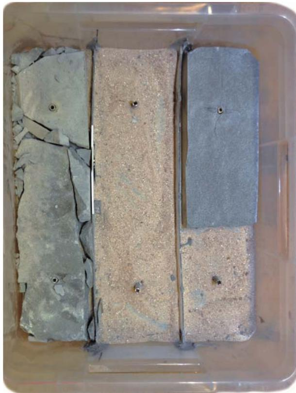
Abb. 39: Einschichten der Materialien für den "Chaosverbundkörper": zu sehen sind links: Scherven, mittig Quarzsand und rechts wieder Scherven. Deutlich erkennbar sind die Injektionshülsen. (Ansicht von oben)
