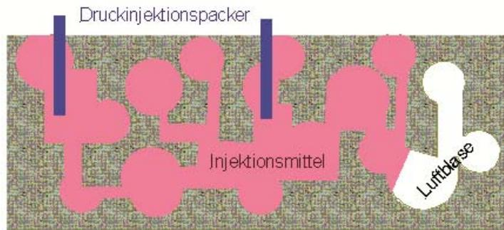
Abb. 32: Blasenbildung bei nicht entlüftender Druckinjektion
