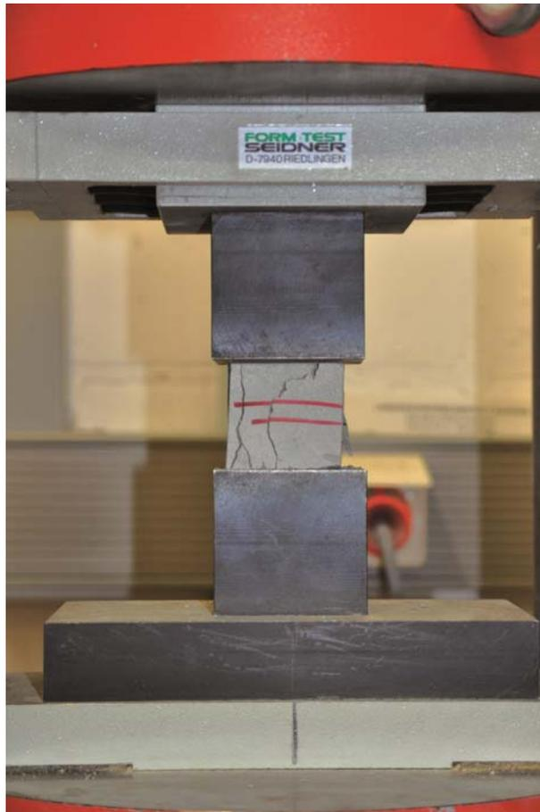
Abb. 56: Maschinelle Druckfestigkeitsprüfung im Labor.
