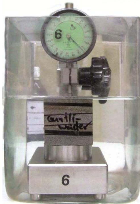
Abb. 59: Messung der Wassersättigung durch Fluten und Dilatation durch konstante Messung.
