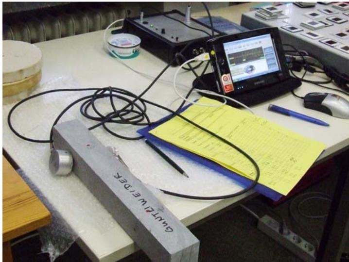
Abb. 55: Messung des dyn. E-Moduls am Sandsteinprisma über Schallgeber und -Empfänger
