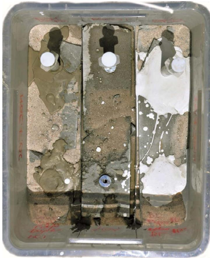
Abb. 47: Verfüllung mit den anorganischen Mitteln BL-Injektionsmörtel, Remmers-Kiesel und PCI-Bohrlochsusension (von rechts).
